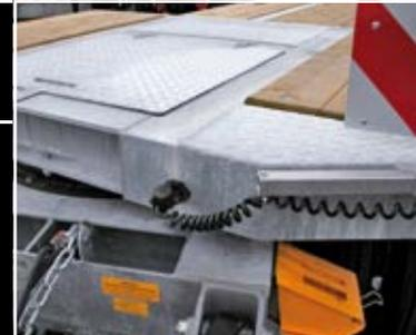
Rahmen verzinkt (nur möglich in Verbindung mit Holzboden)
