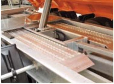
Auffahrampen unter der Brücke eingeschoben (optional)
