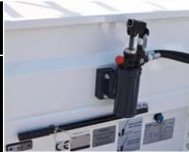
Handpumpe (nur in Verbindung mit dem hydraulisch höhenverstellbaren Zugrohr)
