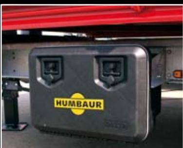
Kunststoff-Werkzeugkasten unter der Ladefläche (geschlossen)
