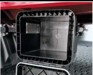
Kunststoff-Werkzeugkasten unter der Ladefläche (geöffnet)
