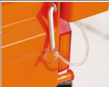
Arretierung der Bordwände in abgeklapptem Zustand
