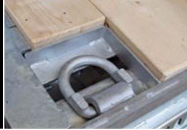
4 Paar Zurringe zur Ladungssicherung im Brückenboden versenkt
