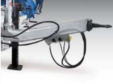
Zentralrohr mit Schraubzugöse 40 mm nach DIN 74054-40 D, über Kurbel stufenlos verstellbar
