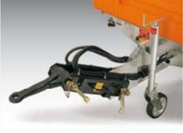
Höhenverstellbare Zugdeichsel über massive Zahnscheiben (nur bei HTK 654020)
