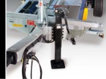
Stützfuß über zweistufiges Getriebe, mit Last- und Schnellgang
