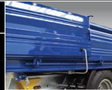
Drehstangenverschluss zur Sicherung der geöffneten Hecktüre
