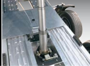
Hartverchromter und kardanisch gelagerter Kippzylinder mit Hubbegrenzung und Schlauchbruchsicherung
