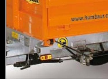
Spindelfeststellbremse zur Sicherung (außer bei 18t)
