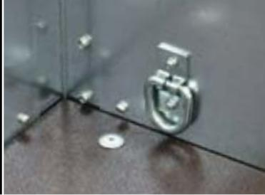
Vier Stück an den Seitenwänden befestigte Zurringe
