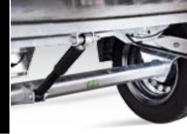
Kippbarer Kastenaufbau mit Stoßdämpferunterstützung
