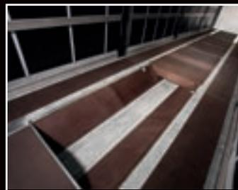
**Belastbar:** Abdeckung der Coilmulde mit Segmentteilen, ausgelegt für eine Staplerachslast von bis zu 5460 kg.
