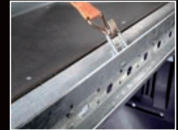
**Das hält:** 1 Paar Zurringe an den Eckrungen vorne, 15 versenkbare Paare im Außenrahmen, zwei klappbare im Abschlussblech.
