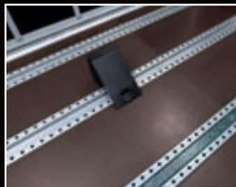
**Rutschfest:** Integrierte Joloda-Lochschienen für Stahlkeile (Lochabstand 60 mm längs und 120 mm quer), mit und ohne Abdeckung.
