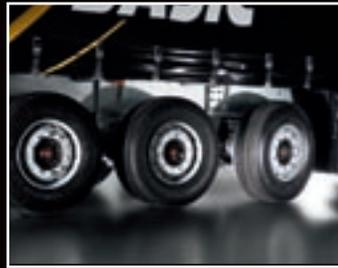
**Qual der Wahl:** Das Dreiachs-Aggregat von SAF ist wahlweise mit Liftachse und/oder Nachlauflenkachse lieferbar.
