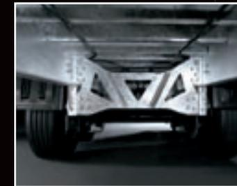
**Patentiert:** patentierte Achsverstrebung (Doppel-C-Träger), der so genannte „Hundeknochen“.
