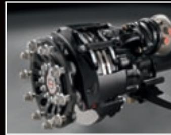
**Gigant(isch):** Gigant-Achse u.a. mit optimiertem Federbock (drei Fahrhöhen von 240 bis 375 mm) und nur 70 mm breiter Lenkfeder.
