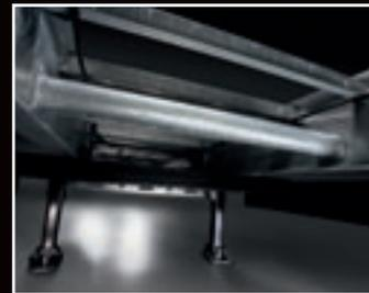
**Keine Verdreher:** Zwei Torsionsrohre verleihen dem Rahmen noch mehr Verwindungssteifigkeit.
