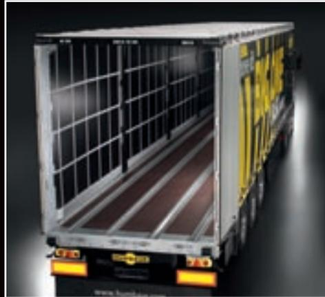
**Open Air:** Das Schiebeerdeck mit weißer Dachplane lässt sich nach vorne hin vollständig öffnen. Die Seitenplane ist über Einhängewellen hinten mit einer Ratsche und vorne anhand eines Hebels spannbear.
