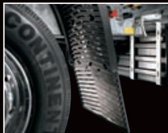
**Durchblick:** In einigen Ländern ist der Spritzschutz am Kotflügel gegen Gischtwolken bei Nässe Pflicht, anderswo ist sie Kür.
