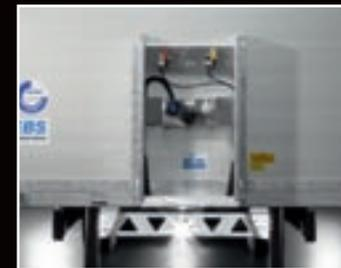
**Alles drin:** Stirnwand aus Aluminium-Hohlprofilen mit Stirnwandstütze und Versorgungsblech für Strom sowie Druckluft.
